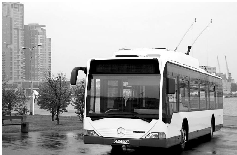
Rys. 2. Autobus MERCEDES O530AC przekształcony na trolejbus [7]
